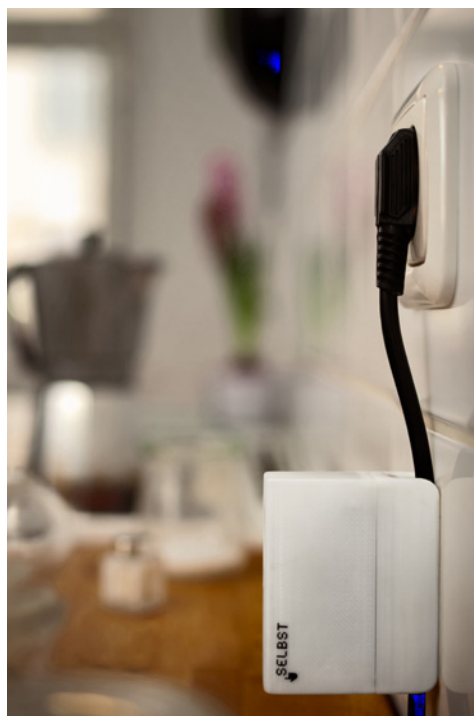
Stromsensor für den Wohnbereich Quelle: Fraunhofer-Institut für Zuverlässigkeit und Mikrointegration (IZM)
